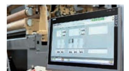
Центральная панель (22'') имеет ясный обзор и позволяет полностью обслуживать станок с пульта управления.
