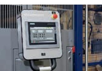
Местная панель (7'') для управления на месте и быстрого обзора всех важных параметров процесса.
