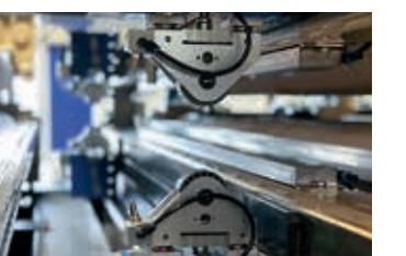
Последовательное измерение толщины для контроля фактических и заданных параметров на К-станции.
