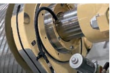
Тонкая настройка контактных валов и/или шлифовальных утюжков посредством двустороннего контроля позиции и индикации.
