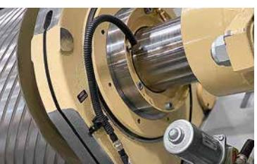
Тонкая настройка контактных валов и/или шлифовальных утюжков посредством двустороннего контроля позиции и индикации.
