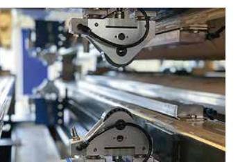
Последовательное измерение толщины для контроля фактических и заданных параметров на К-станции.
